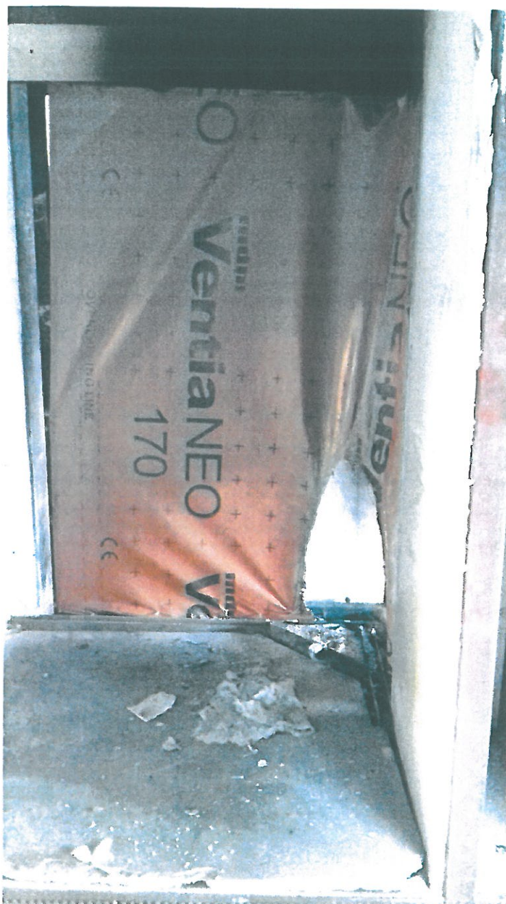
Zdjęcie nr 3 - Membrana po badaniach na podłożu niepalnym,
