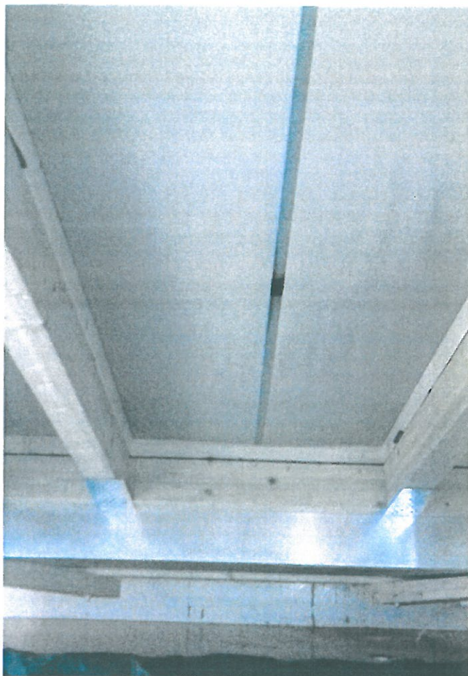
Zdjęcie nr 2 - Spodnia strona Membrany mdm® Ventia Neo 170 podczas testu - brak widocznej penetracji wilgoci
