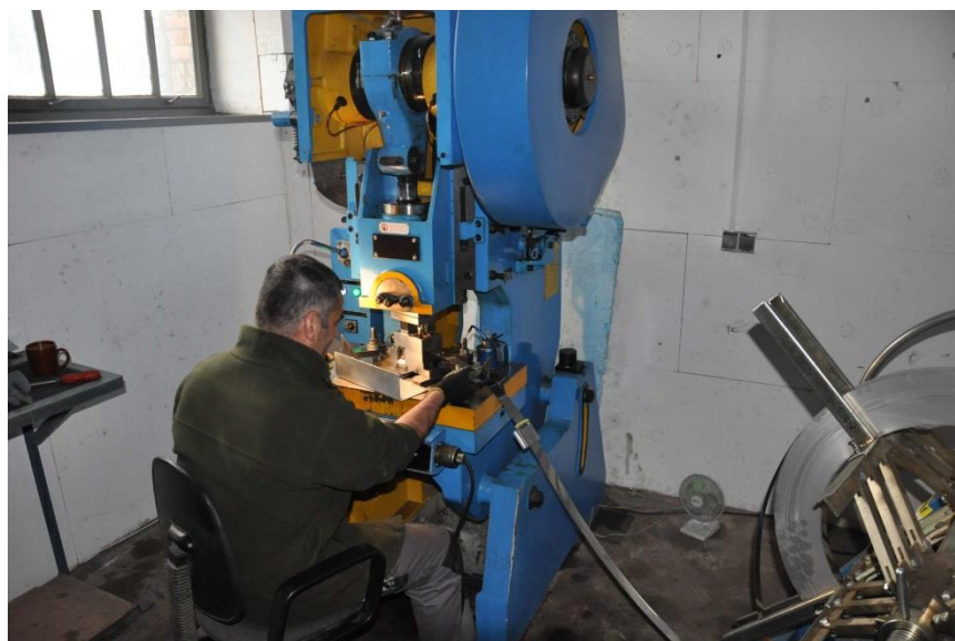
Rys. 7.2. Prasa mimośrodowa (manualna) oraz rozwijak stanowiące jedno stanowisko robocze w północno-wschodniej części zaplecza technologiczno-magazynowego firmy „Dach i Strych”
