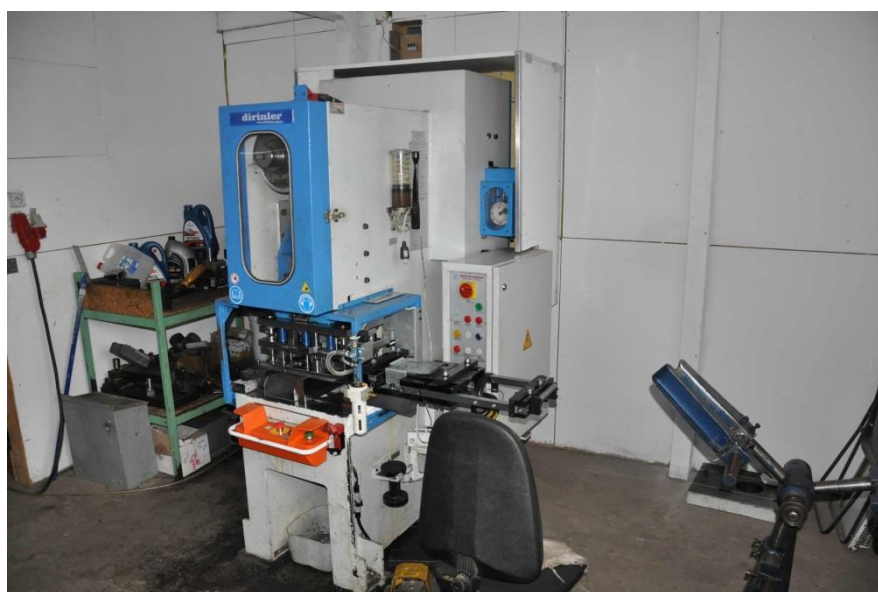
Rys. 7.3. Prasa mimośrodowa firmy DIRINLER oraz rozwijak, będące najnowocześniejszym stanowiskiem roboczym w części zaplecza technologiczno-magazynowego firmy „Dach i Strych”
