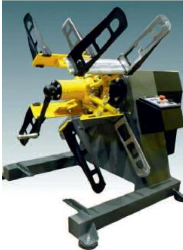
Rys. 7.7. Zmotoryzowany rozwijak uzupełniający zaproponowany zestaw produkcji zaczepów kątowych ZK [40]
