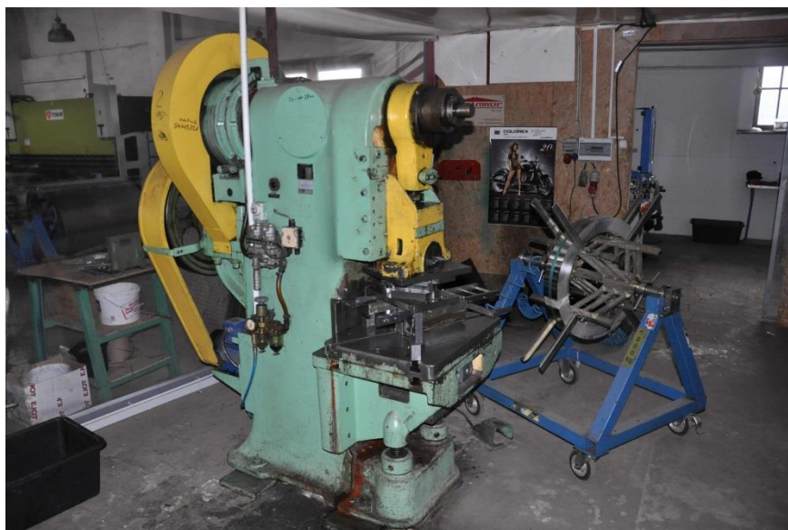
Rys. 7.1. Prasa mimośrodowa (manualna) firmy HENSEL oraz rozwijak stanowiące jedno stanowisko robocze w północno-zachodniej części zaplecza technologiczno-magazynowego firmy „Dach i Strych”
